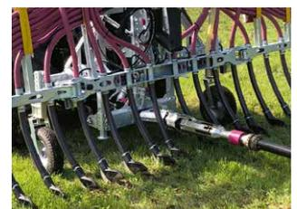
Sur le nouveau tuyau d'entrée, le point de traction se trouve proche du sol et le flexible est suffisamment éloigné de la double roue dans les virages.
